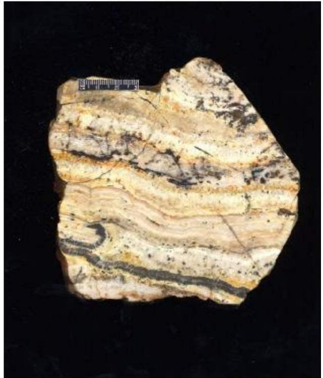
Рис. 1. Колломорфно-полосчатые текстуры золото-серебряных руд. Светло- серое до белого - срращения кварца с адуляром и иногда серицитом; темное - бонанцы (тонкозернистый агрегат электрума с науманитом, агвиларитом и эмболитом). Полированные штуфы.
