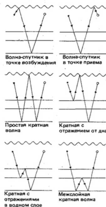
Рис. 2. Лучевые траектории поясняющие основные схемы образования кратных волн.
